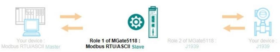
Your device : Modbus RTU/ASCII Master      Role 1 of MGate5118 : Modbus RTU/ASCII Slave      Role 2 of MGate5118 : J1939      Your device : J1939
